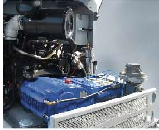
Die horizontale Bauweise der robusten 3 Plunger-Hochdruckpumpe spart Platz und erleichtert Service- und Wartungsarbeiten ungemein.
